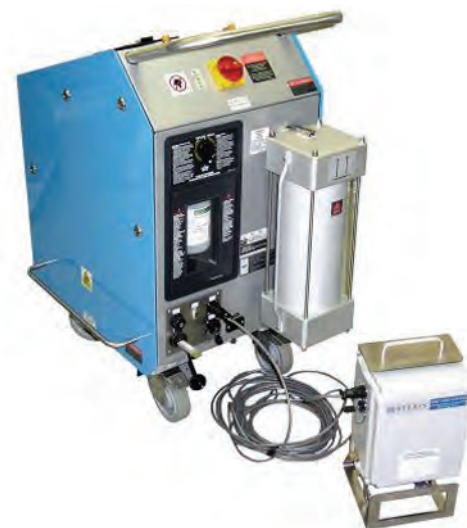
Sistema de biodescontaminación VHP® 1000-ARD con unidad de detección
