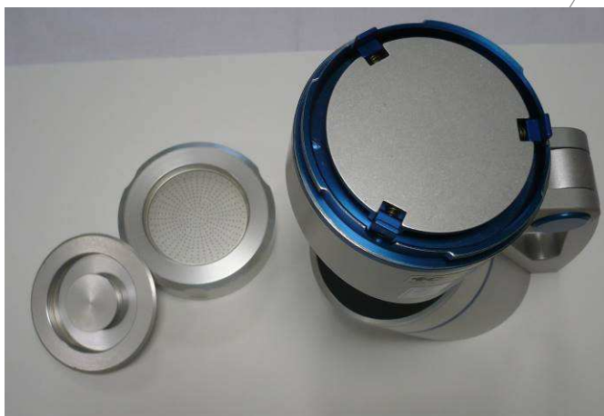
Muestreador abierto, cabezal y tapa
