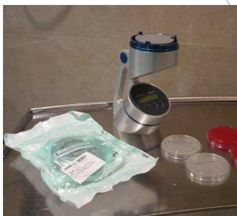
Muestreador y cabezal estéril
